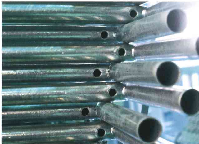
写真4 パイプ手すりの接続部 亜鉛の流出入を良くするために直径の35%の穴をあけている。
