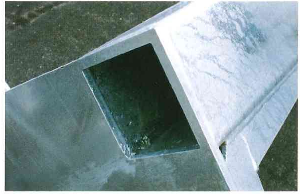
写真2 角パイプで作られた建屋部材 ベース開口部が角パイプ内径より小さいため亜鉛だまりがある。
