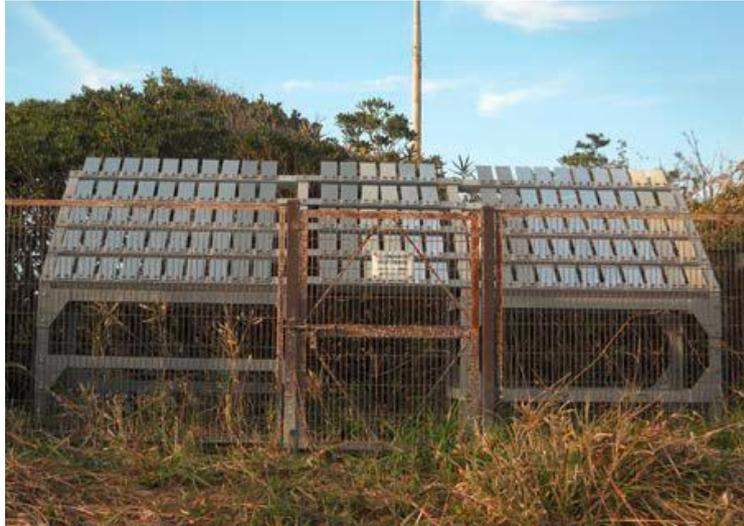
写真2 試験片の大気暴露状況（田園地域）
