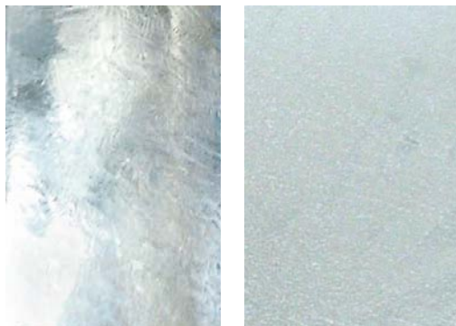
写真6 通常の亜鉛めっき(左)と合金めっき(右)
